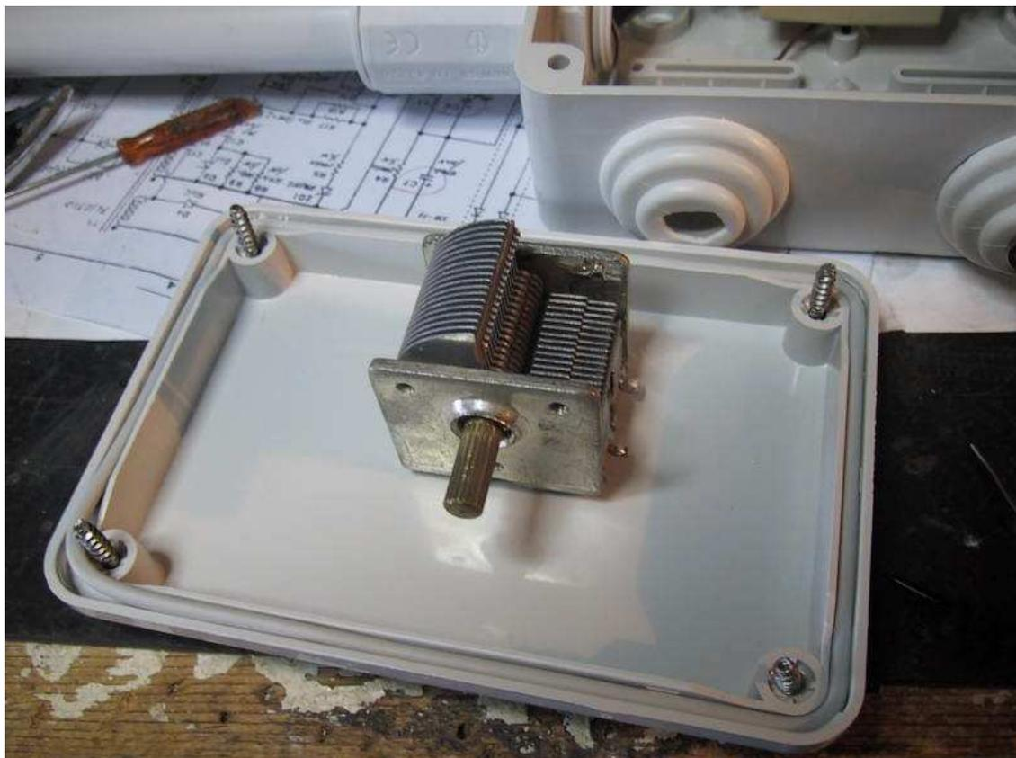
La costruzione è quasi terminata....fissate il condensatore variabile all'interno della scatola facendo fuoriuscire il perno di comando, su cui installerete una grande manopola.
