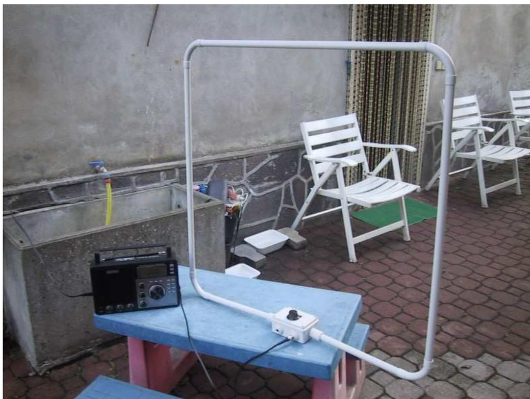
La seguente antenna è stata realizzata per migliorare la ricezione in onde medie di un qualsiasi ricevitore casalingo, meglio se dotato di presa per il collegamento di un'antenna esterna.
