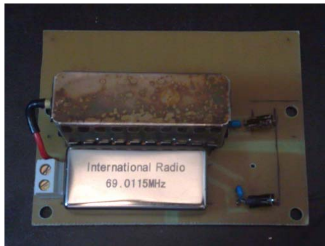
Vista del roofing filter homemade: Filtro a quarzo INRAD e amplificatore post filter
